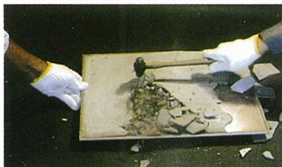
打撃状況、面連結性無し (タフバインダー無し)
