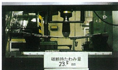
タフバインダー 無 タイル落下有 (落下時たわみ量 23.5mm)
