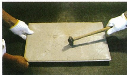
打撃状況 (タフバインダー有)
