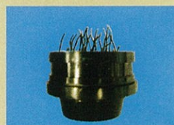
◀ 試験後のスーパー loopボンドの状況
