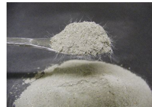
モルタル(粉体)中の タフバインダーの分散状態
