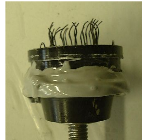
試験後のスーパーループボンド
